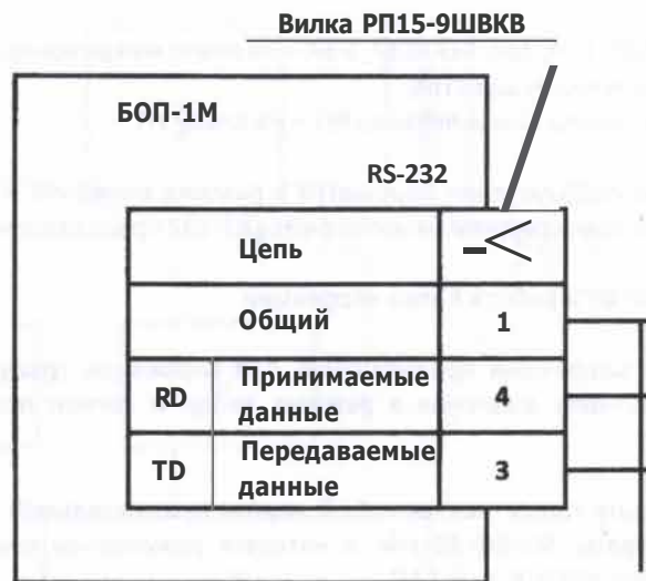
Рисунок 5 - Схема электрическая подключения барометра
